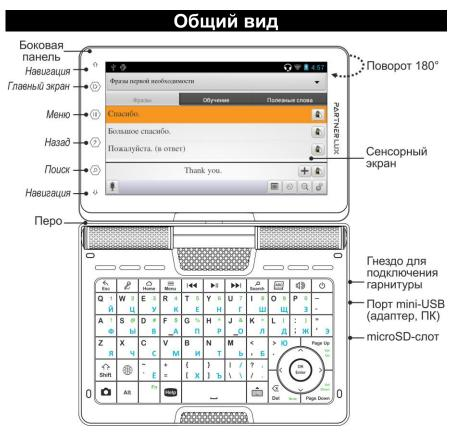
Благодаря поворотному экрану устройство легко трансформируется в удобный планшет. Допустимый угол поворота экрана от исходного положения — 180° по часовой стрелке. Возврат экрана в исходное положение осуществляется поворотом на 180° против часовой стрелки.
